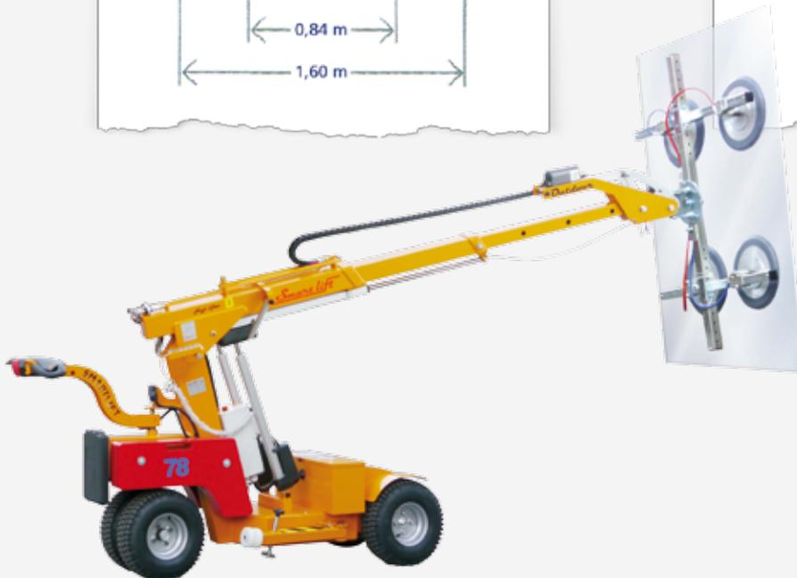
Der Hebearm ist mit einem zusätzlichen Ausschub ausgestattet, mit dem eine noch größere Reichweite erzielt werden kann.
